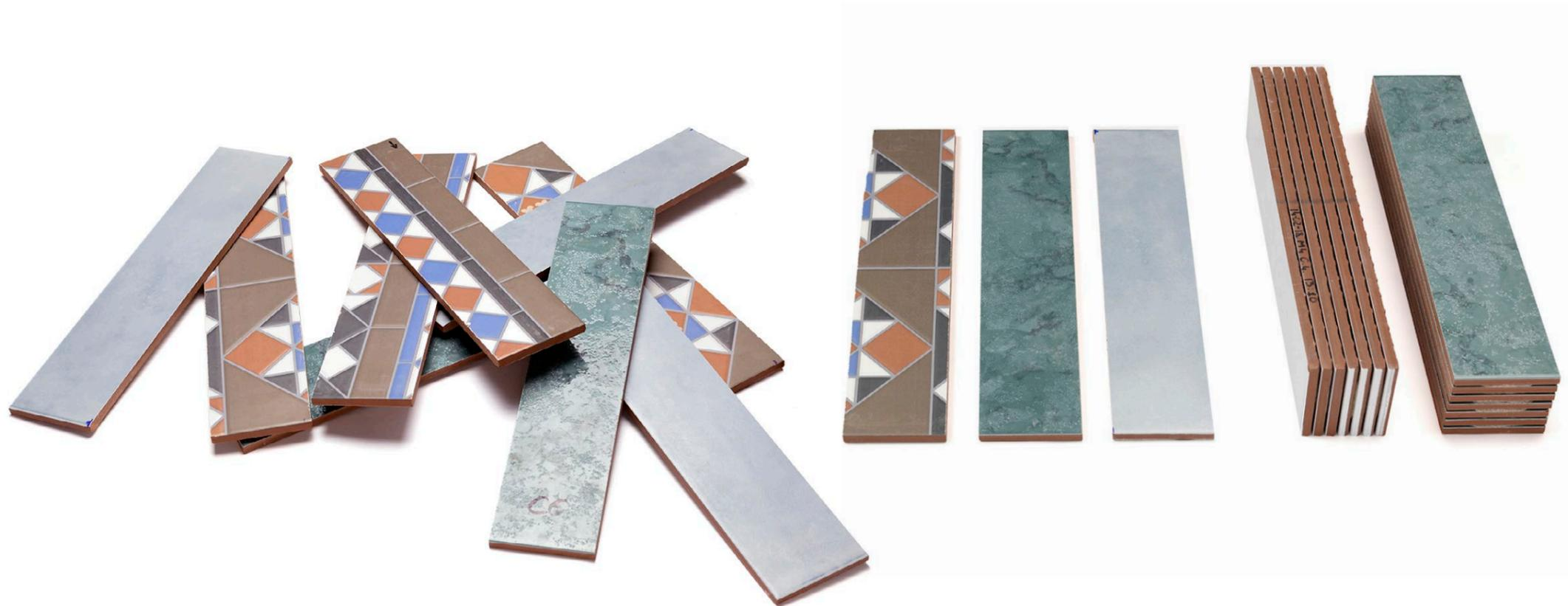
Esquema de fabricación del módulo cerámico: Baldosa, Cintas, Encolado y Adoquín.
